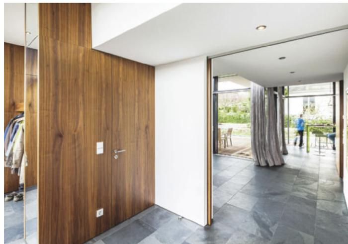
*/ Flexible Raumtrennung: Eine in die Wand einlaufende, breite und in der Decke geführte Schiebetür in Nussbaum trennt bei Bedarf den Flur vom Wohntrakt.*
